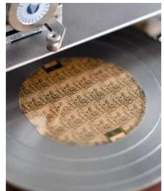
Halbleiter-Wafer mit GaN-Transistoren für 5G- und 6G-Basisstationen.
