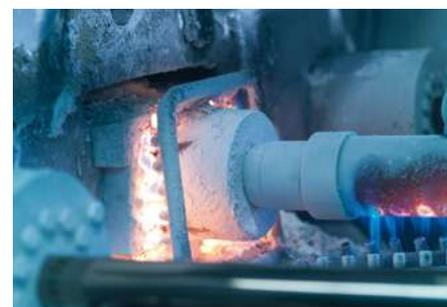
*Gasbetriebener Magnesiumdruckgussprozess: Ansatzpunkt für eine bivalente Energieversorgung.*
