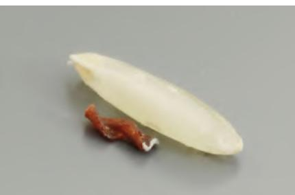
*Der Mikroroboter ist 3 Millimeter lang und 1,2 Millimeter im Durchmesser. Damit ist er kleiner als ein Reiskorn.*
