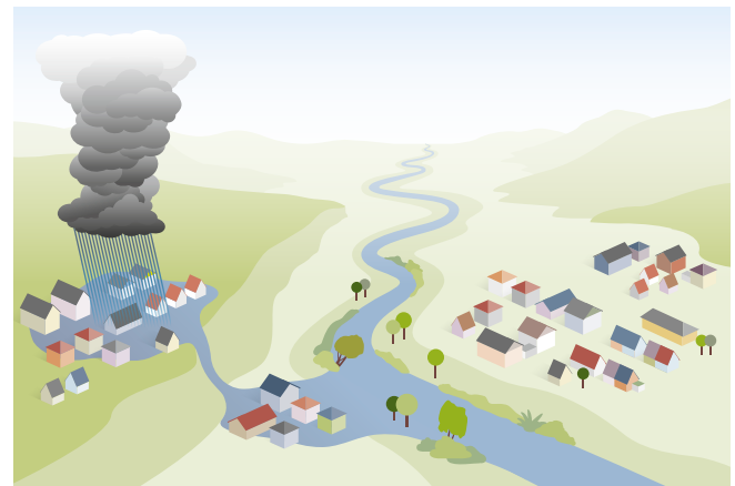
Fluviales Hochwasser (links) entsteht durch länger anhaltenden Regen und geht von einem Gewässer aus; pluviales Hochwasser (rechts) entsteht durch lokal begrenzten Starkregen direkt auf der Geländeoberfläche und kann daher überall auftreten.
