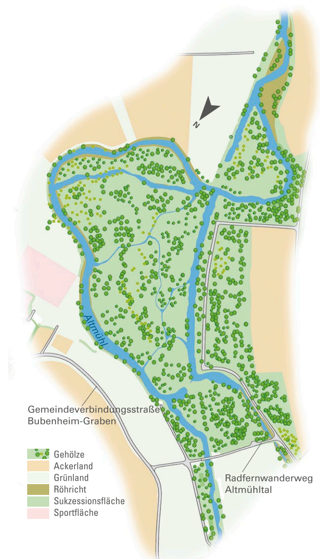
Planung für die Schaffung eines Auwalds im Abschnitt Graben, mit Verlegung der Altmühl in ihr ursprüngliches Gewässerbett
